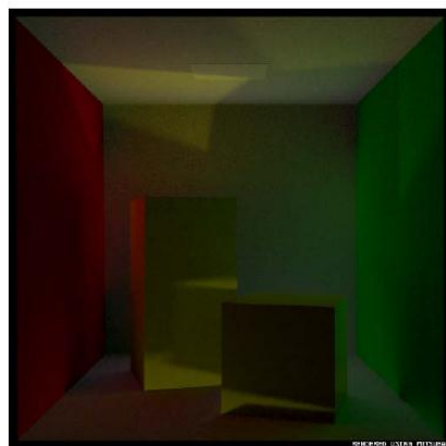
Naše řešení (dotaz do PM na všech vrcholech cesty do kamery + kombinace pomocí MIS)
